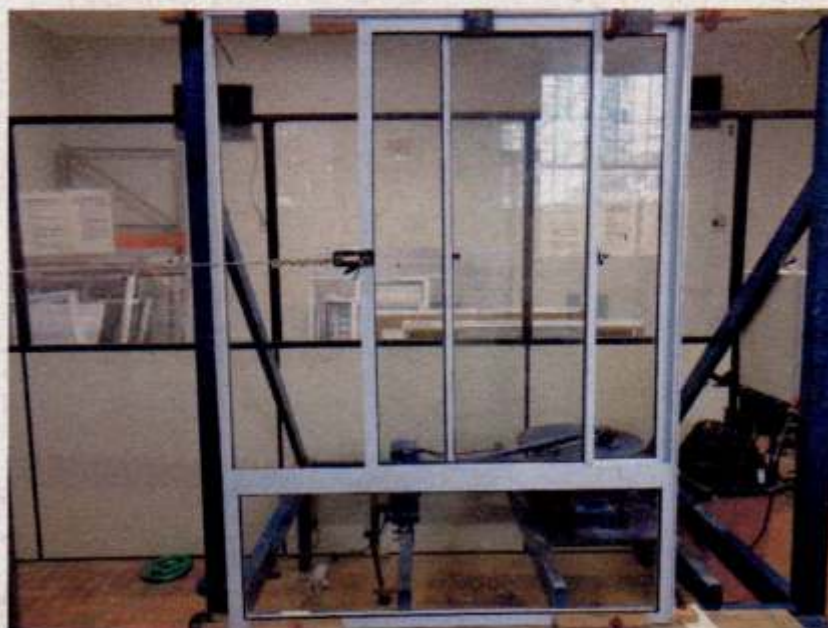
Foto nº. 03 Resistência ao esforço horizontal, com dois cantos imobilizados.
