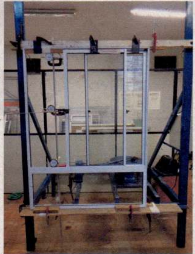
Foto nº. 02 Resistência ao esforço horizontal, com um canto imobilizado.
