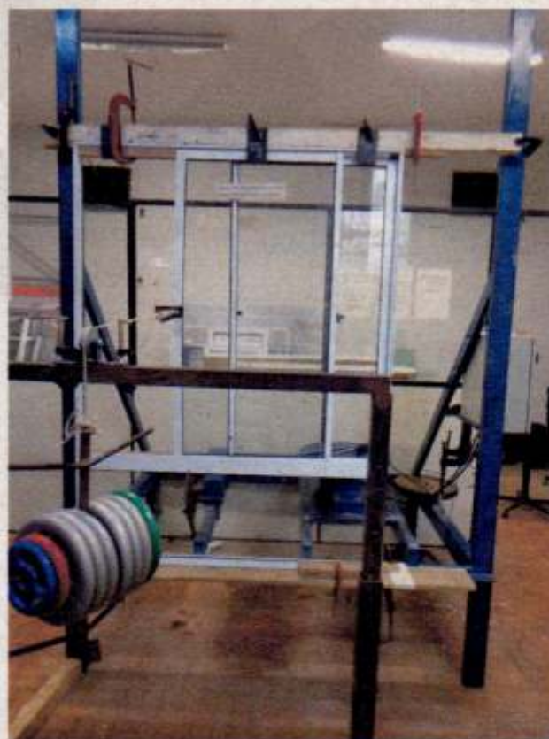
Foto nº. 03 Resistência ao esforço horizontal, com dois cantos imobilizados.
